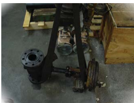
Réfection d'une vanne de régulation.
