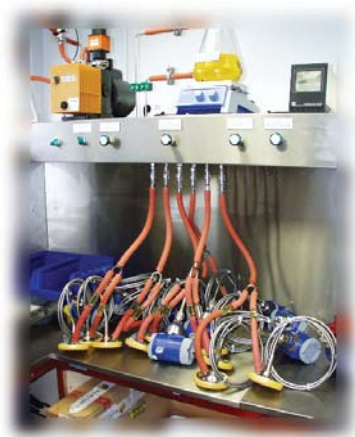
Assemblage de transmetteurs différentiels sur séparateurs.
