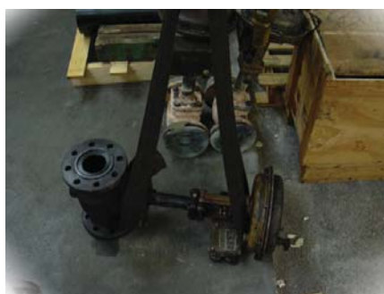
Réfection d'une vanne de régulation.
