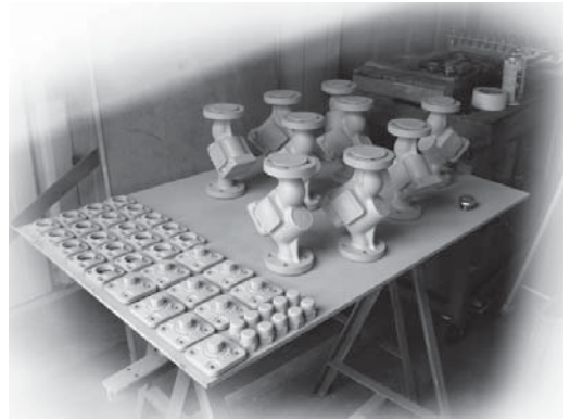
Remise en état de purgeurs ARI, Armstrong, Byvap, Sarco ....
