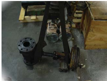
Réfection d'une vanne de régulation.
