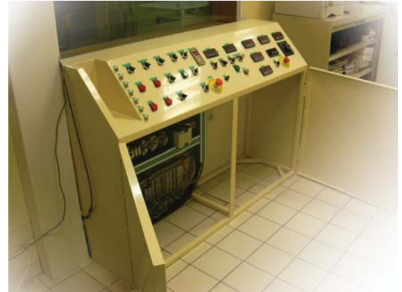
Banc de test destiné au contrôle des échappements du char Leclerc. "Défense Nationale".
