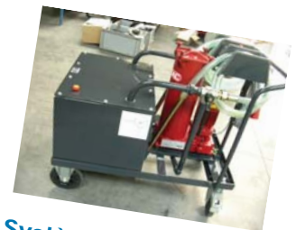
Système de filtration mobile.
