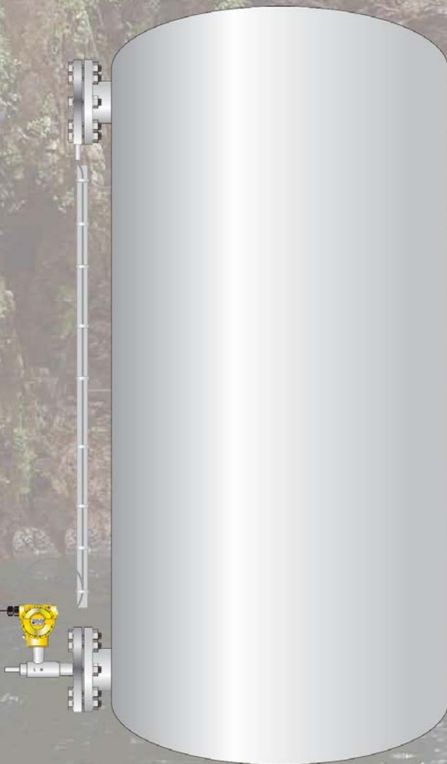
Mesure de niveau manométrique.
