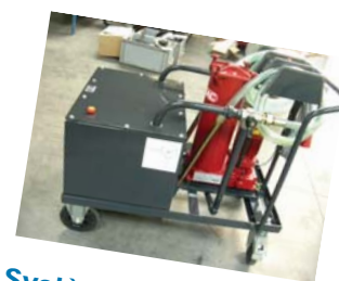
Système de filtration mobile.
