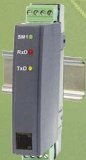
Modules de conversion de signaux analogiques, courant, tension, résistance et Pt100Ω. Deux (SM1) ou quatre (SM2) voies indépendantes en entrée. Sorties digitales RS-485 et RS-232 MODBUS en mode RTU et ASCII. Sorties isolées galvaniquement
