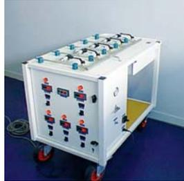
Réalisation d'un banc mobile de test d'étanchéité pour l'épreuve des radiateurs des moteurs d'automobiles.
