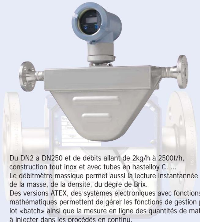
Du DN2 à DN250 et de débits allant de 2kg/h à 2500t/h, construction tout inox et avec tubes en hastelloy C, ... Le débitmètre massique permet aussi la lecture instantanée de la masse, de la densité, du degré de Brix. Des versions ATEX, des systèmes électroniques avec fonctions mathématiques permettent de gérer les fonctions de gestion par lot «batch» ainsi que la mesure en ligne des quantités de matière à injecter dans les procédés en continu.
