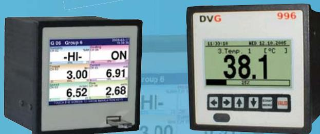
Les afficheurs graphiques proposent de 1 à 8 voies de mesure avec des entrées en température ou des signaux analogiques 0-4/20mA.
