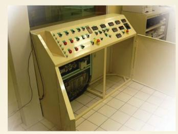
Banc de test d'échappement du char Leclerc.
