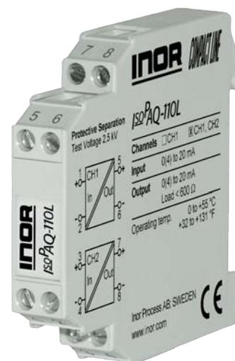
L'ISO PAQ-110L est une isolation galvanique miniature pour les signaux 0(4)-20mA, disponible en 1 et 2 voies. Son utilisation permet de supprimer toutes erreurs de mesure liées à des mises à la terre, à des différences de potentiel ou qui résultent de points communs sur l'alimentation des boucles.
